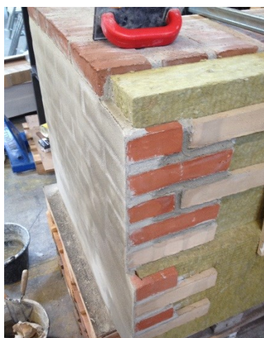
FIGUR 9 FORSØG MED HJØRNELØSNINGER PÅ GAVLISOLERING
