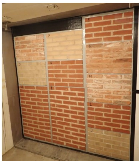
FIGUR 6 OPSTILLING AF PRØVEEMNER I KLIMAKAMMER HOS TEKNOLOGISK INSTITUT
