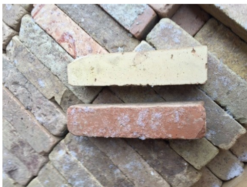
FIGUR 2: FORSKEL PÅ KANTERNE PÅ ET UBEHANDLET MIDTERSTYKKE (ØVERST) OG ET BEHANDLET MIDTERSTYKKE (NEDERST)
