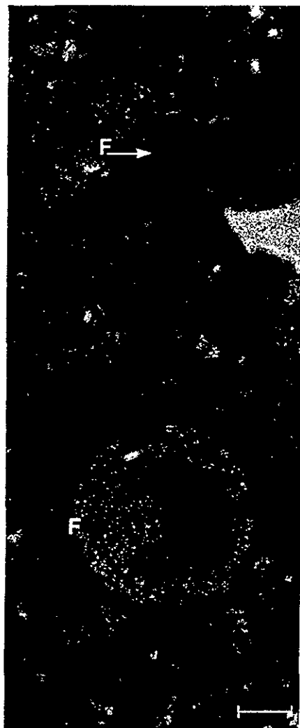
Figur 11. x250 (målestav 0,03 mm). I denne cementpasta ses, ud over en del cementkorn, 2 flyveaskepartikler (F), dels en rund, sort kulpartikel og dels en hul glaskugle. Krydsede nicoller og gipsblad.
