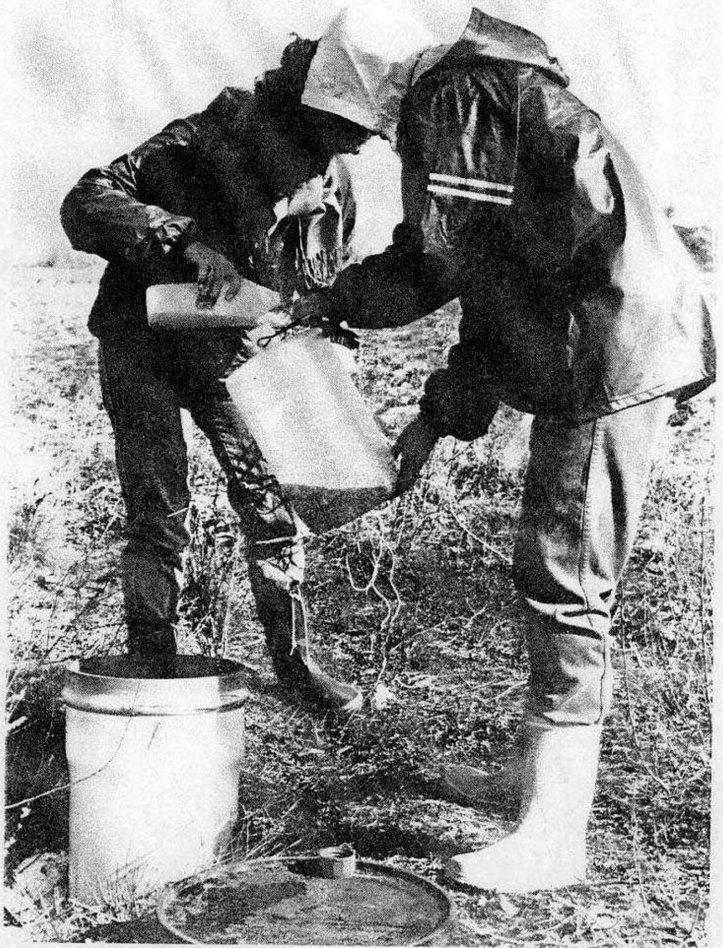
4. Prøveudtagning ved perkolatbrønd KB 3 (andet affald, etape 1)
