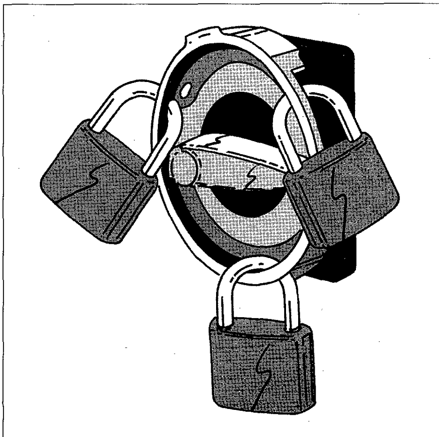
Fig 2.1 Eksempel på en reparationsafbryder.
