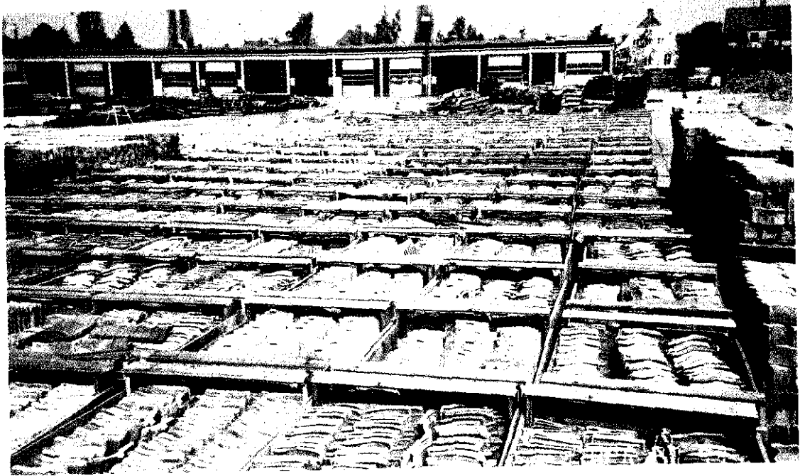
Figur 7 Oplagrede tagtegl af forskellig type til genanvendelse. Tagteglene er oplagrede hos Københavns Kommunes Tekniske Service.
