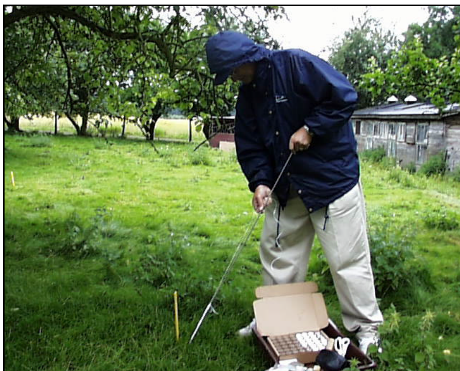
Figur 1 Installation af Gore-Sorber modul ved hjælp af snor og spyd.
