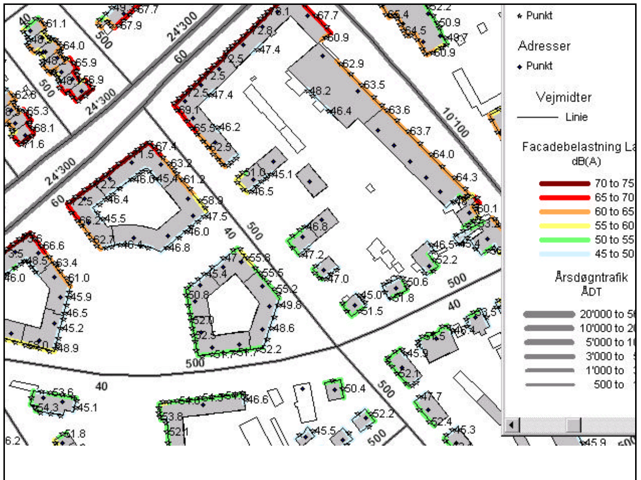
Figur 3.1 Støjregningsmetoden. Udsnit af caseområdet med angivelse af Adressepunkter, beregningspunkter og støjbelastning på facadekanter. ÅDT og hastighed er knyttet til vejmidterne.
