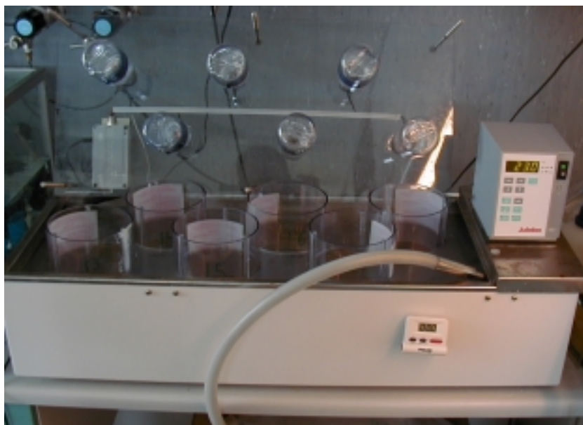
Figur 3.2. Cylindre klar til isætning. Slange til køleanlæg ses forrest til højre.
