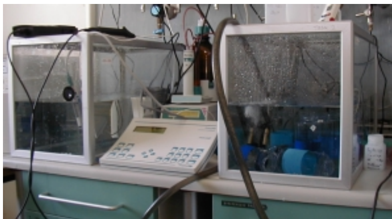
Figur 3.3. Cylindre samlet i et akvarie til forsøg 2. De lyse slanger, der løber ned foran højre akvarie går til spandpumpe, der er placeret på gulvet. Radiometers pH-Stat ses imellem akvarierne, og referencetermometer på venstre akvarie. Bagerst i billedet ses flaske og toppen af Methrom's pH-stat.
