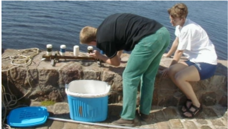
Figur 3.4. Inspektion af cylindre på dag 7 – styregruppen noterer sig begroning eller svovl/okker angreb på de to mørkeblå cylindre.
