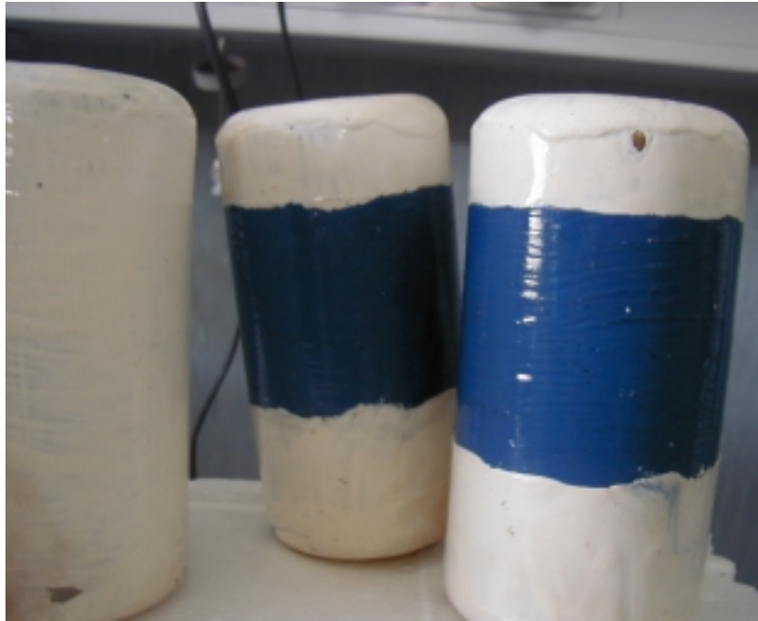
Figur 4.17. Nærbilled af mørke (lavt udludende) cylindre (cylinder nr. 33+34). Der ser ikke ud til at være begroning på disse.
