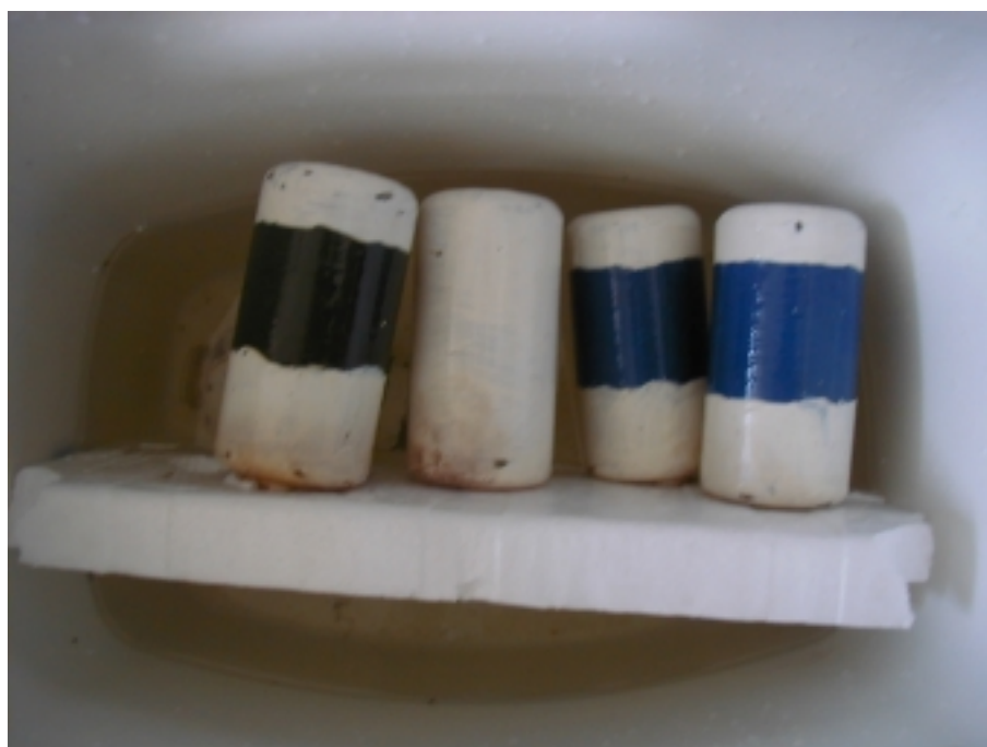
Figur 4.16. Cylindre fra Roskilde fjord fotograferet d. 16/5-2000 (dag 7). Cylindrene fotograferet i køletasken som blev anvendt til transport (bemærk Roskilde fjordvand i bunden af tasken). Under transporten var cylindrene neddykket i vandet.
