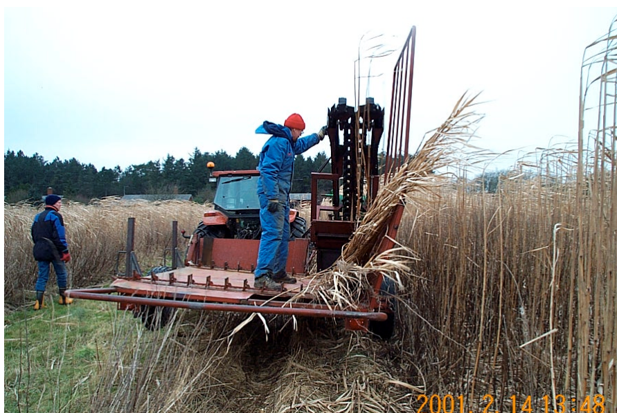
Figur 2. Høst af strå af elefantgræs ( M. 'Giganteus' ) med nyudviklet maskine fra Hvidsted Energiskov.
