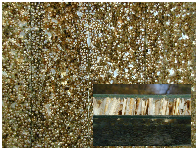
Figur 8. Helstråkomposit med overflader af glas set dels fra overfladen og i indsat billede på tværs af kompositten.
