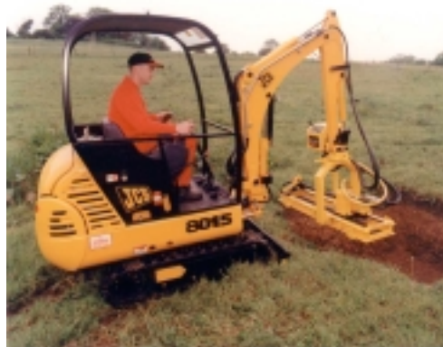
Det integrerede udstyr sætter pit-model i jorden.
