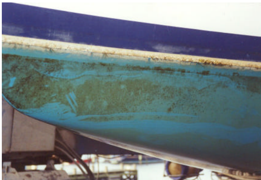
Figur 29: Billedet viser bagbordsside med Lyseblå maling (samme båd på samme tid som figur 28). Også den Lyseblå maling er slimbelagt, men ikke i samme grad som den Mørkeblå (Bemærk i øvrigt, at en del af bunden er rensset med en hånd eller evt. vandstråle).
