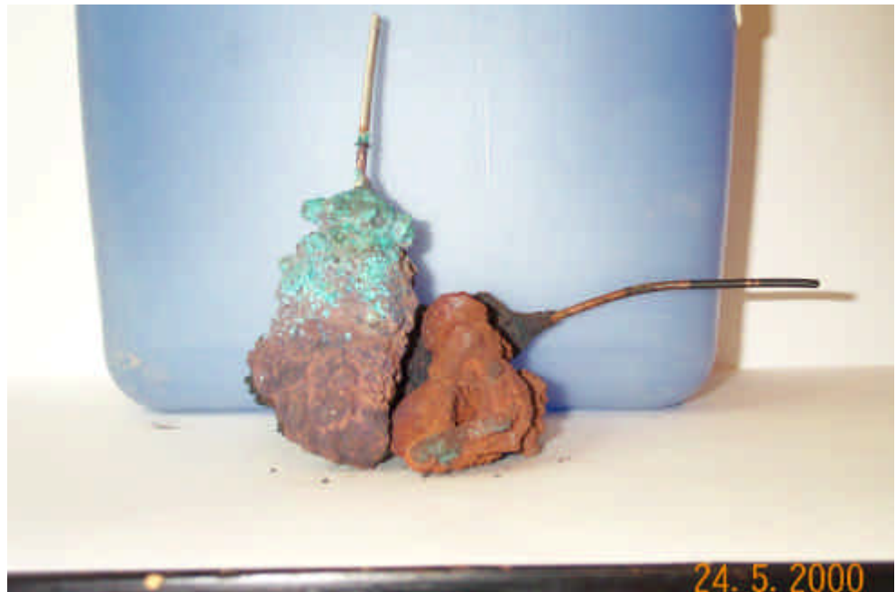
Figur 2.5: Metallisk kobber udfældet ved elektrolyse af elektrolytter fra opkoncentreringskammer.
