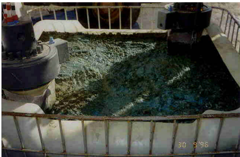
Figur 4.1: Pilotforsøg med elektrodespyd i en 1m 3 palletank.
