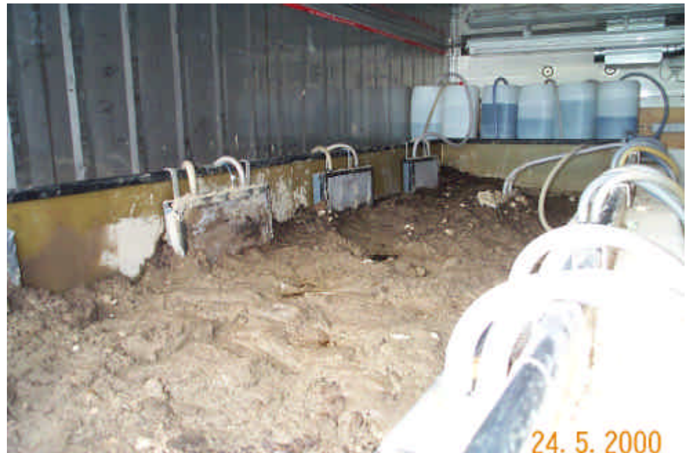
Figur 7.2: Pilotanlæg med jord fra Dansk A-træ
