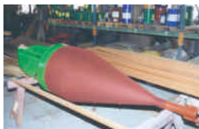
Figur 6. Ny SealCoat belægning på vager
