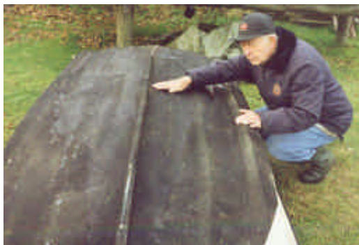
Figur 4: SealCoat efter 5 måneder i vandet. Billedet er taget inden afrensning..
