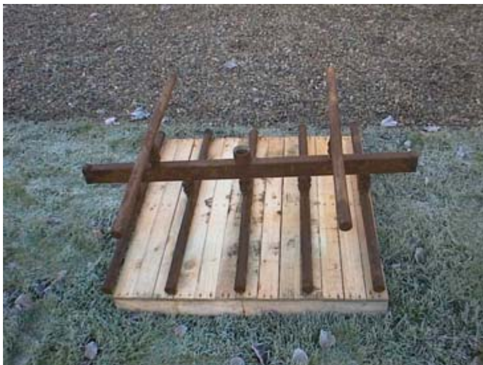
Figur 2: Diffusor-konstruktion i luftningssektion bestående af 14 rør.
