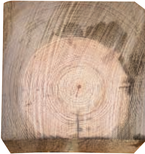
GENNEMSKÅRET BJÆLKE AF NYT TRYKIMPRÆGNERET TRÆ. BEMÆRK DET TYDELIGE MØNSTER AF GRØN IMPRÆGNERINGSVÆSKE RUNDT OM KERNETRÆET
