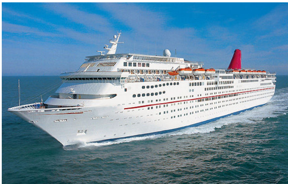
KRYDSTOGTSKIBE HØRER TIL BLANDT DE STØRSTE PÅ HAVET. DE STØRSTE AF SKIBENE KAN HAVE FREMDRIVNINGSMASKINERIE MED EN EFFEKT PÅ CA. 50.000 kW OG HJÆLPEMASKINERIE MED EN EFFEKT PÅ CA. 15.000 kW
