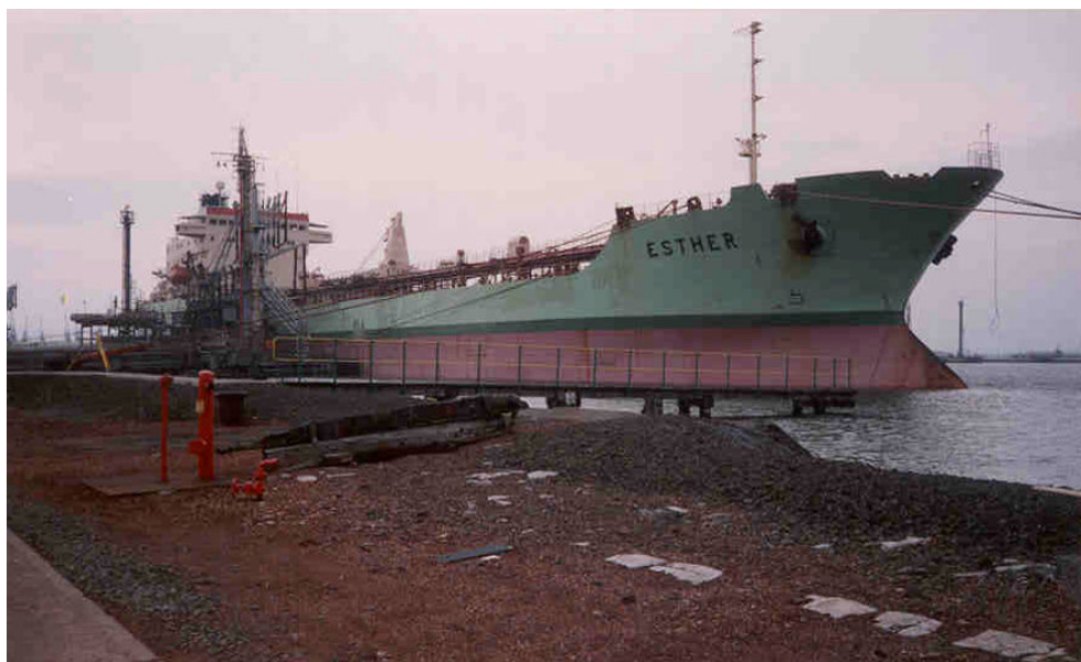
TANKSKIB UNDER LOSNING. TANKSKIBE KAN HAVE MEGET BETYDELIGE FORBRUG TIL DRIFT AF PUMPER UNDER LOSNING OG LASTNING. EFFEKTFORBRUGET KAN F.EKS. UDGØRE CA. 30% AF DEN INSTALLEREDE EFFEKT PÅ HOVEDMASKINERIET
