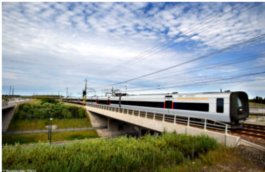
Togbeklædningsprofiler fremstillet af Fiberline Composites A/S til Bombardier 'Øresund' tog
