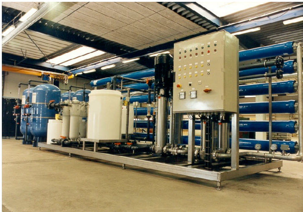
Figur 2.2 Eksempel på opbygning af et membranlæg med spiralvundne membraner /Billedet udlånt af UNIQ Filtration/
