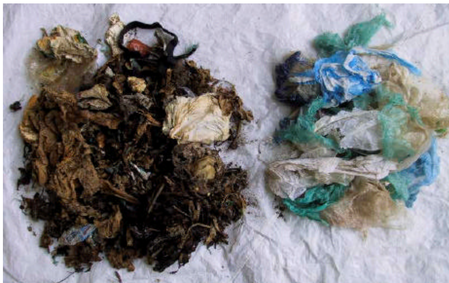
Billedet 5: R-98 affald med usædvanlig højt indhold af tynd poseplast. Billedet viser en portion tørret rejkt, hvor den tynde poseplast er lagt i en bunke for sig.
