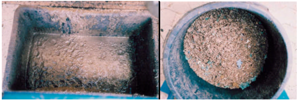
Billede 7: Typisk kvalitet af rensede biomasse og rejekt fra snegleseparatoren.
