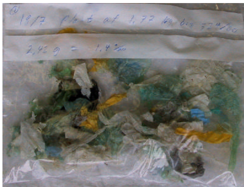
Billede 8: Plast indhold i 1,77 kg biomasse fra stempelseparatoren.
