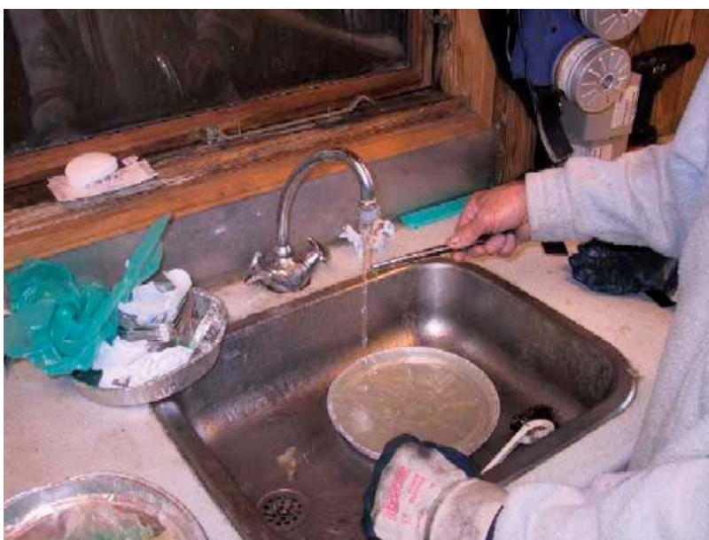
Figur 6 Vask af plastrester fra vådfase før vejning
