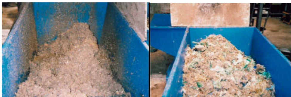
Billede 6: Typisk billede af biomasse og rejekt fra stempelseparatoren.
