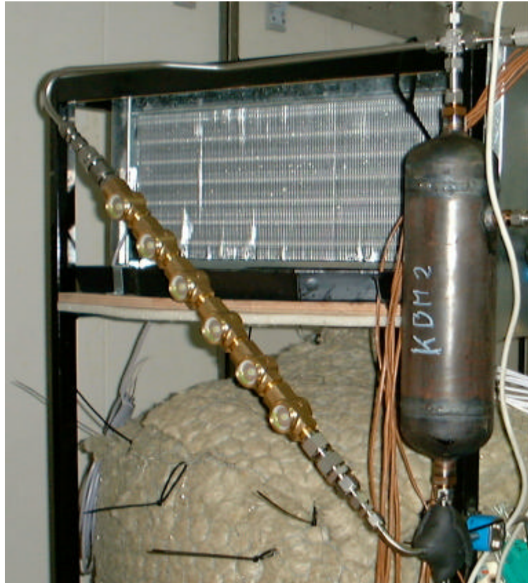
Figur 3.9: Bil lede af receiver og skueglas med fordampere synlig i baggrunden
