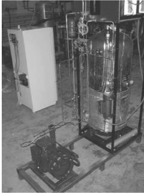
Figur 3.4: Billede af prototype før isolering af beholder og montering af måleudstyr
