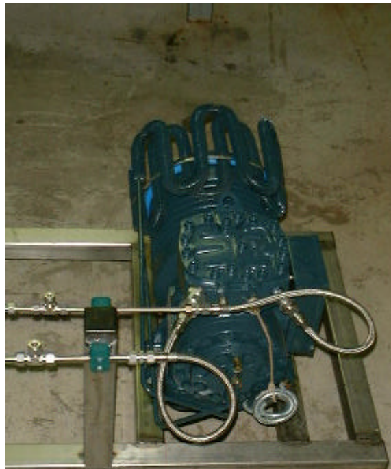
Figur 3.6: Billede af Dorin semihermetisk \text{CO}_2 -kompressor til transkritisk drift
