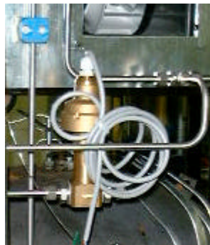
Figur 3.8: Billede af højtryksventil
