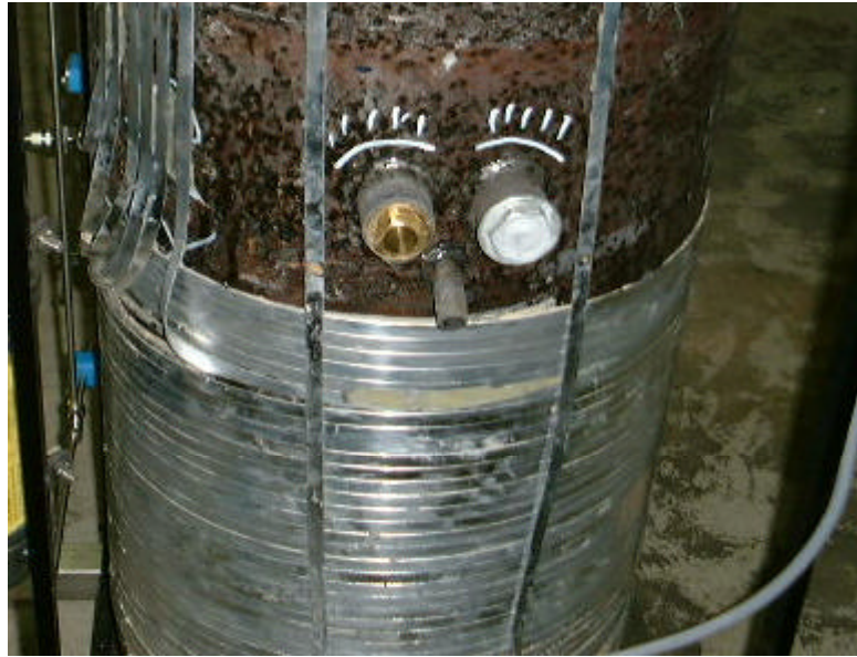
Figur 3.7: Billede af gaskøler viklet på beholder
