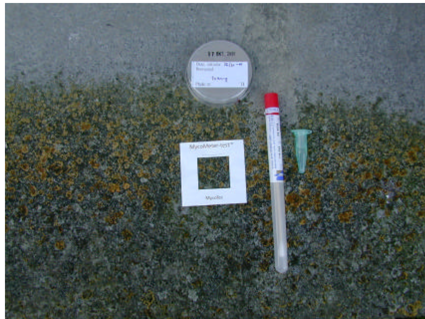
Figur 10.2 Materialer til MycoMeter-test samt Rodac-plade på sålbænk med bevoksning af bl.a. laver.
