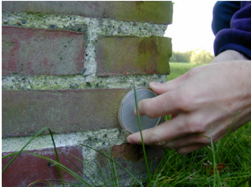
Figur 10.1 Rodac-plader anvendt til test af vækst før og efter afrensning af muret facade med alge-bevoksning
