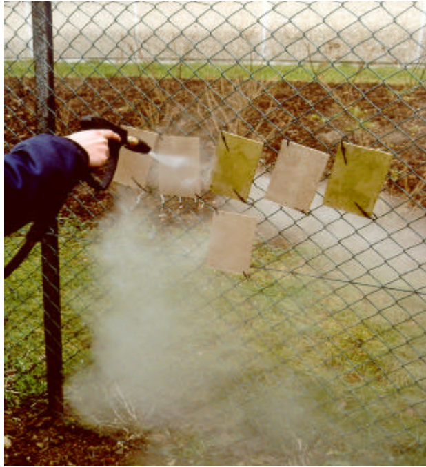
Figur 11.4 Forsøgsopstilling med hedvandsafrensning på Teknologisk Institut, Murværk.
