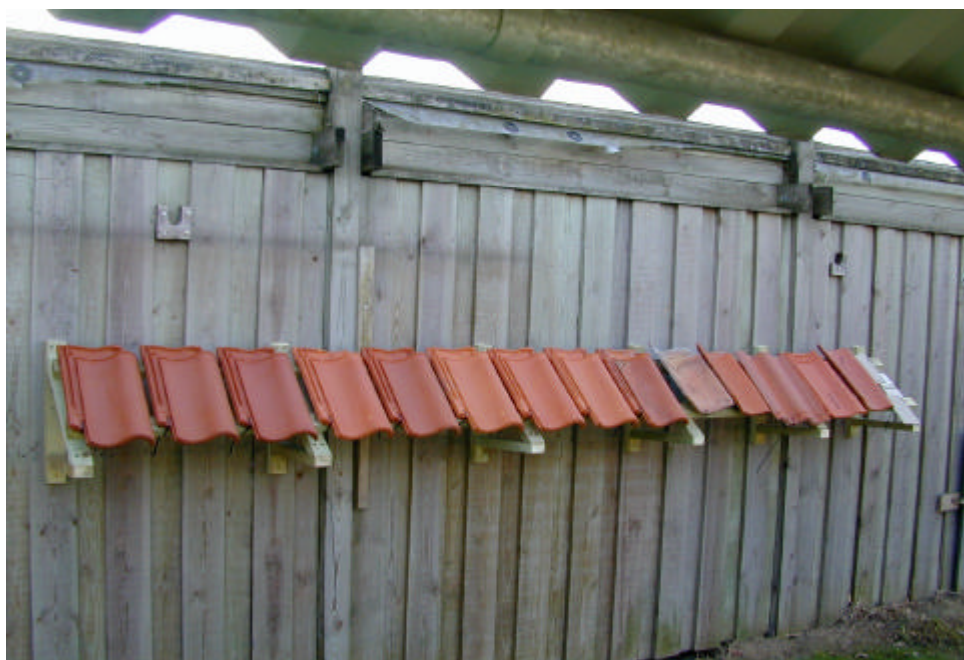
Figur 11.7 Feltspånering af testemner efter hedvandsrensning.
