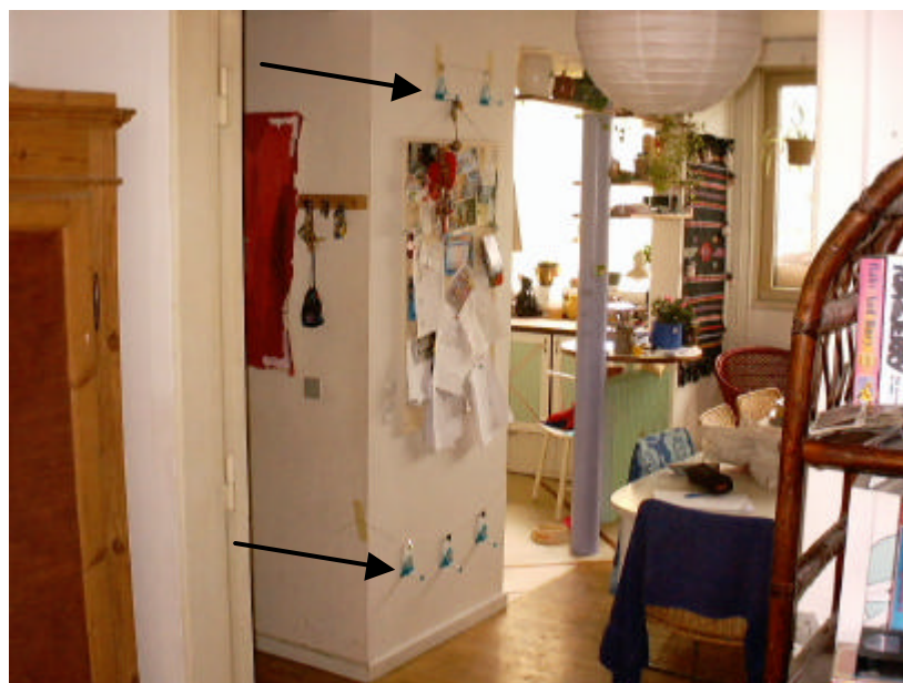
Figur 4.5: Eksempel på sampleropsætning på én position (2 niveauer):
