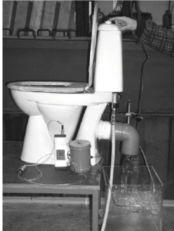
Figur 4.3 Forsøgsopstilling til bestemmelse af skyllekarakteristik for et urinsorterende kloset
