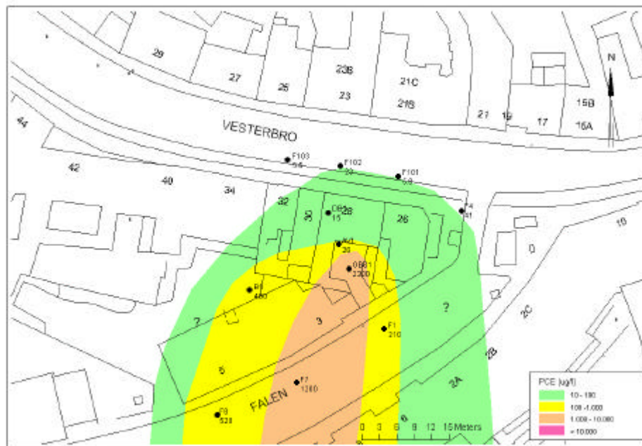
Figur 6.2 Forureningsudbredelse i grundvandet før oprensning (øverst) og efter 14 måneders drift (nederst).
