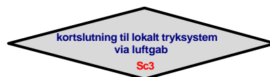
Figur 2.5: Sekundær fejl af typen betjening. Beskrivelsen af fejlen står i elementet, mens det lille nummer nederst i cirklen henviser til et nummer, hvor fejlen er yderligere uddybet.
