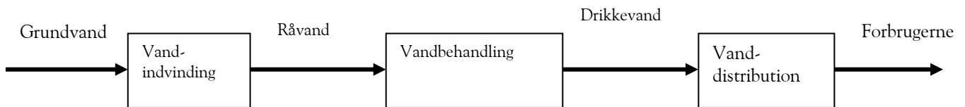
FIGUR 2.2 VANDFORSYNINGENS GRUNDLÆGGENDE PROCESDIAGRAM
