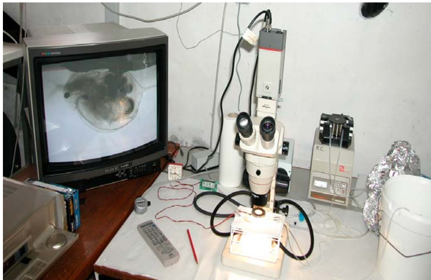
FIGUR 3. FORSØGSOPSTILLING TIL VIDEOREGISTRERING AF EFFEKTER PÅ FYSIOLOGISKE PARAMETRE HOS D. MAGNA .
