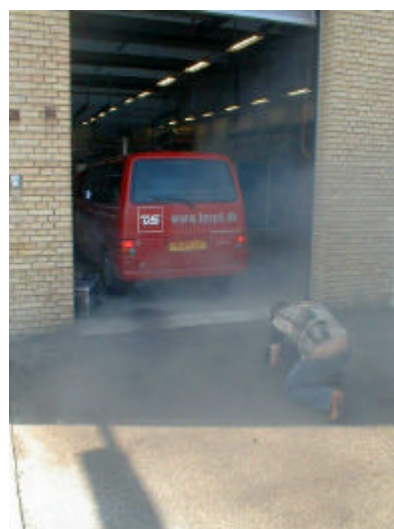
Bil l ede 3-1 og 3-2. Røgdviking under fuld lasttesten med tuningsboksen monteret.
