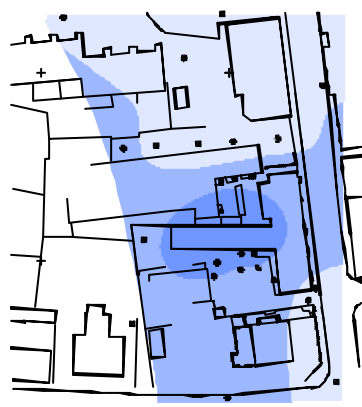
PCE-koncentration i øvre filter, december '99 (2 uger efter stop af 2. driftsscenario og før start af 3. driftsscenario)
