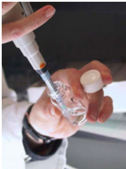
Figur 3. Der udtages prøver fra algesuspensionen ved start og de to følgende dage, så væksten i algenes biomasse kan følges. Algenes biomasse estimeres ud fra fluorescensen af pigmenterne, (primært klorophyll a ) ekstraheret i acetone. Der er et lille hul i låget til vialen, der sikrer kulstofligevægt mellem luft og algediedet.
