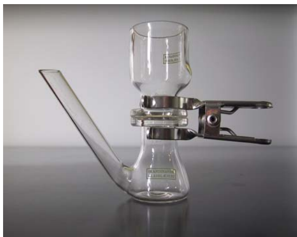
Figur 1. Diffusionscelle af glas til penetrationsforsøg.
