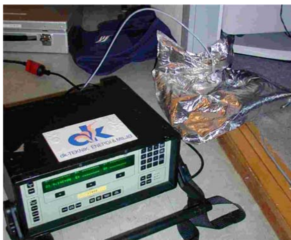
Figur 18. Case D: Sniffermåling på indtrængning fra dørtrin ved hjælp af afdækning med VaporCover og måling af PCE med PAS instrument.
