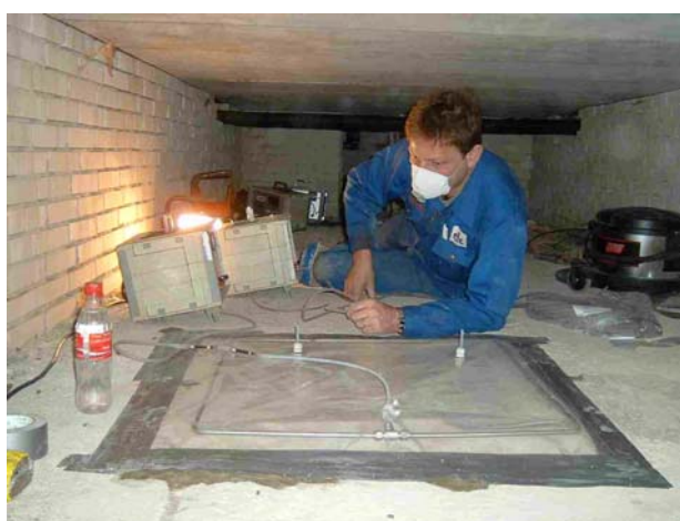
Figur 16. Case C: Måling af flux ved hjælp af foliemetoden i målepunkt 1.
