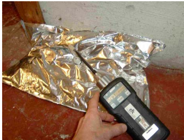
Figur 3. "VaporCover" prototype, benyttet sammen med ppb-RAE PI-detektor.
