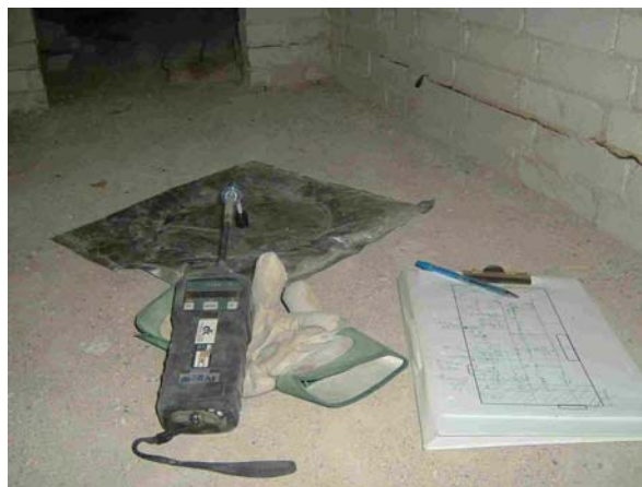
Figur 13. Udførelse af sniffermålinger med PI-detektor i krybekælder: Case C.
