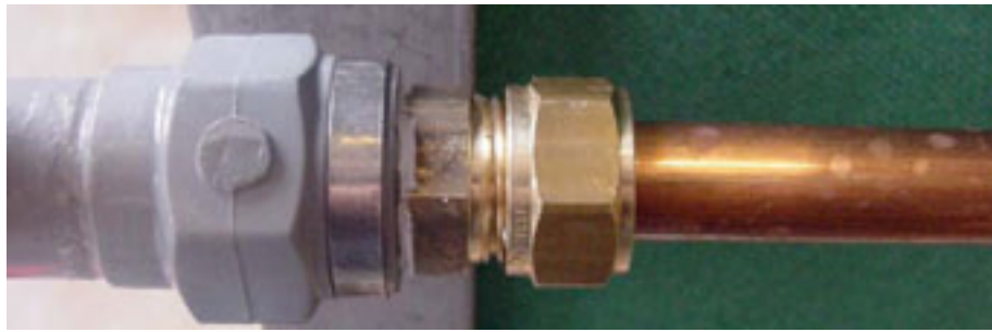
Figur 9. Installationsdetalje fra testrig. Kobberrør med overgangsfittings af messing. Der er gevindsamling mellem messing og plast.
