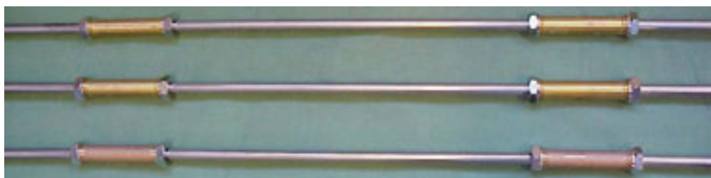
Figur 6. Standard testemner monteret i rør af rustfrit stål. Indeholdt vandvolumen i fittings relativt til testrør er tilnærmet 15 %. Se også Appendix C og F.
