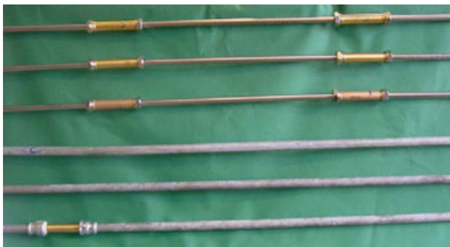
Figur 7. Testemner, som monteret i Lysholt. De 3 øverste, emne 1, 3 og 5, er kobberlegeringer, som er monteret i rustfri rør (15%). De 3 nederste rør, emne 7, 9 og 11, er af varmforzinket stål.
