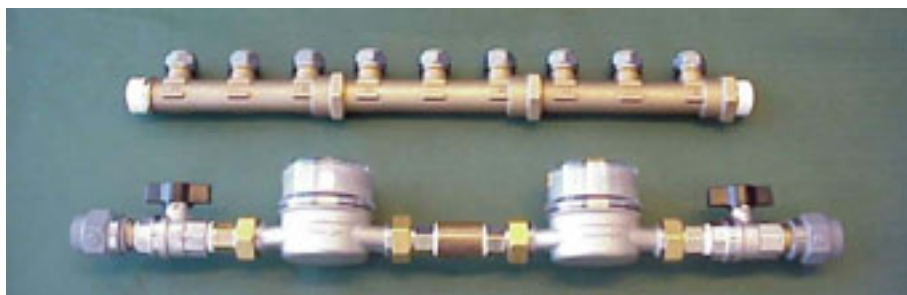
Figur 5. Eksempler på sammenkoblede testemner fra forsøgsperioden 2002-2003 eksponeret på Lysholt Vandværk. Øverst ses fordelerrør af afzinkningsbestandig messing, A-metal, emne 17/18. Nederst ses vandmåler med afspærringsventil og fittings, emne 19/20. Dette emne indeholder både almindelig messing og DZR-messing. Måler og ventil er forniklet.
