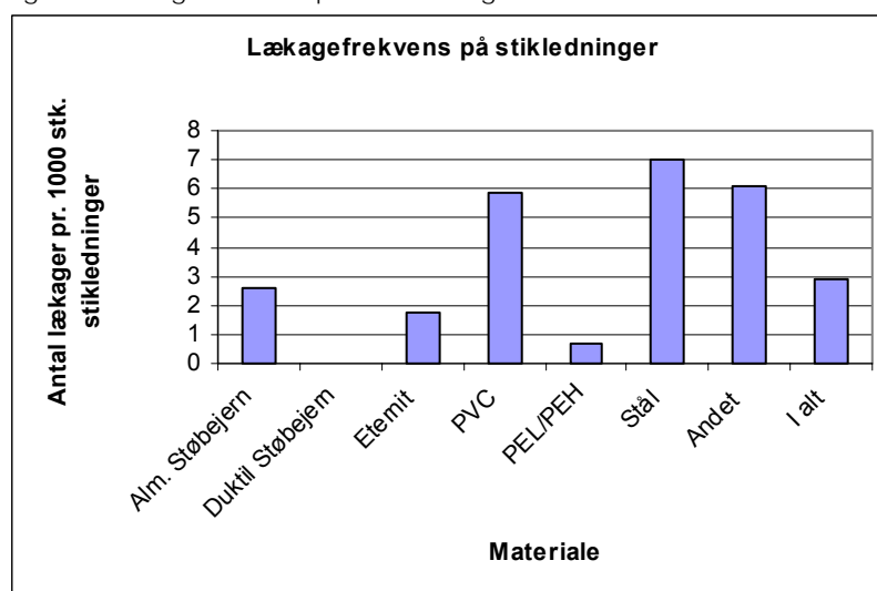
Figur 5.5:Lækagefrekvens på stikledninger
