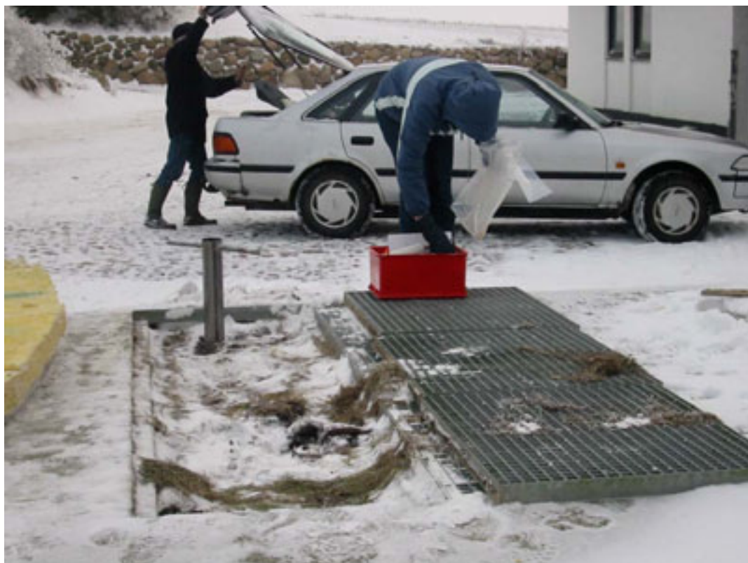
Figur 6.13. Biobed opbygget på gård ved Odder. Jordprøver udtaget med jordbor omkring det område, hvor påfyldningsbeholderen findes under fyldning.
