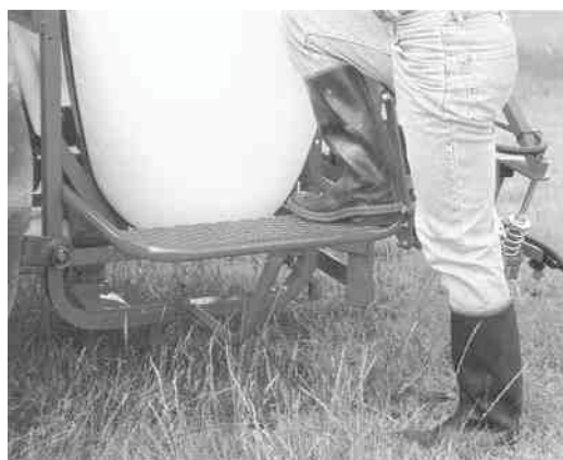
Figur 2.3. Skridsikkert trinbræt ved siden af beholderen.
