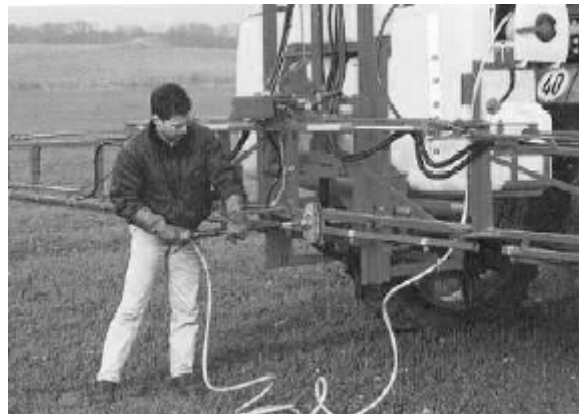
Figur 5.4. Udvendig rengøring på marken med børste (Vicon, Kverneland Group Danmark A/S).
