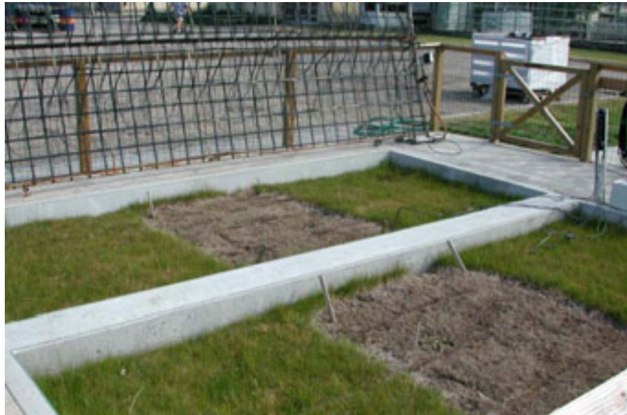
Figur 6.5. Billede af det behandlede biobed taget omkring august, hvor skaden på græsset er meget tydelig. Skaden er bredere end det behandlede areal, som er afgrænset af de gule pinde. Rammen i baggrunden er et drypvandingsanlæg til supplerende af nedbør, for at sikre en jævn fordeling. (Foto: Henny Rasmussen).
