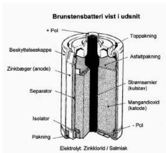
Figur 2.1. Skematisk opbygning af brunstensbatteri /1/
