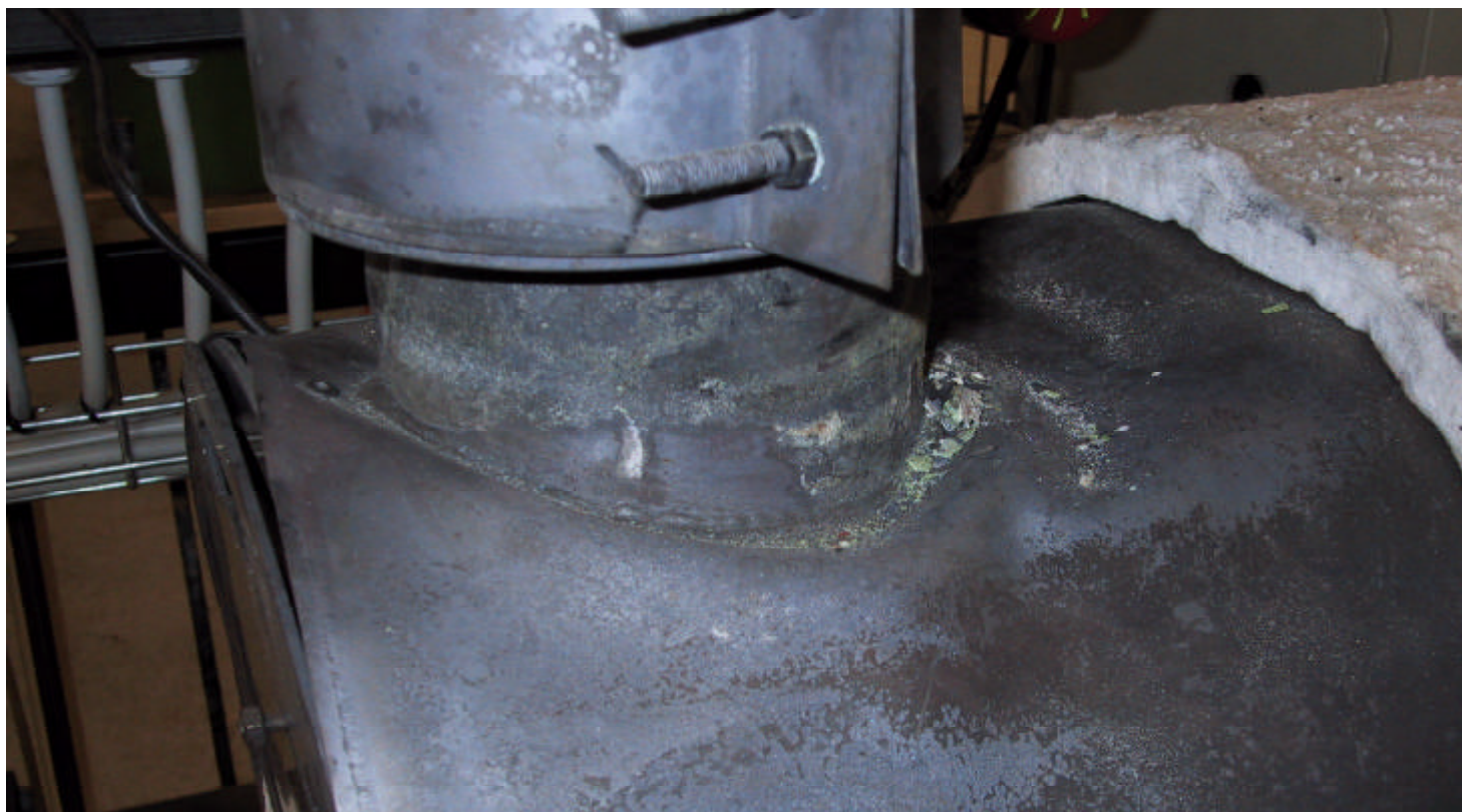
Figur 1.4 Inertgasbrænderen blev noget bulet pga. varmen.
