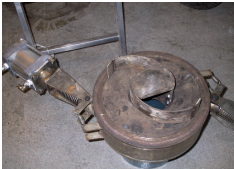
Figur 1.3 Udtagsmodul inden havari
