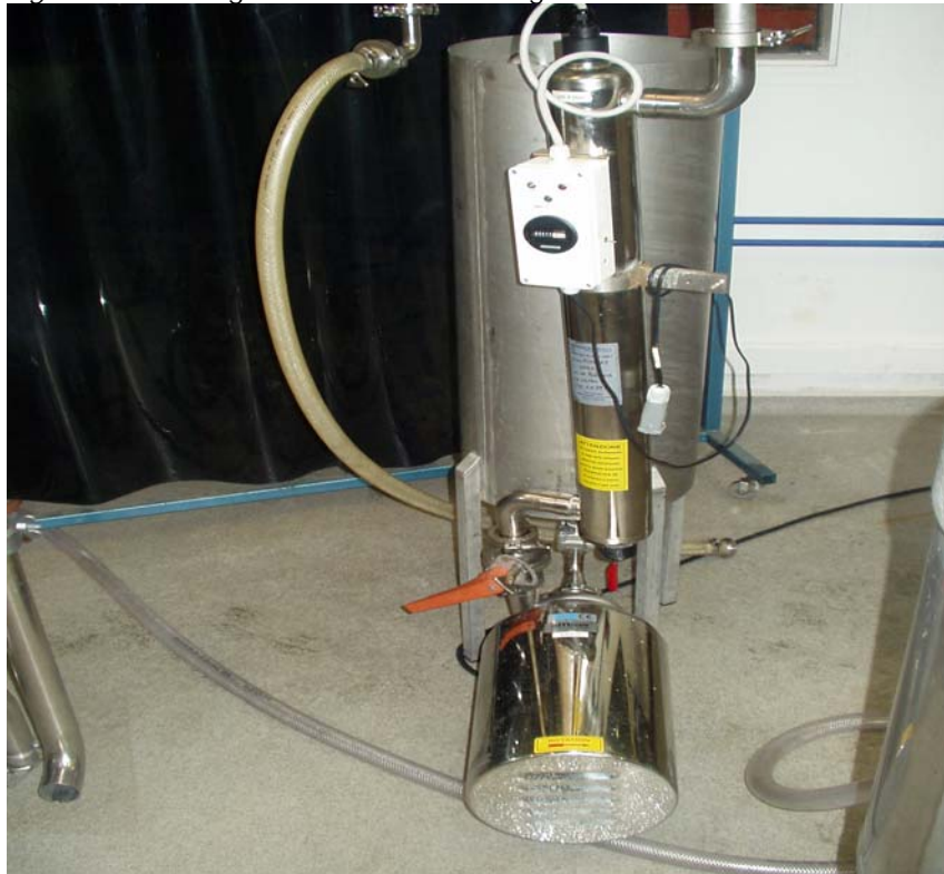
Figur 5.1 UV-anlæg anvendt i trin 2 forsøg
