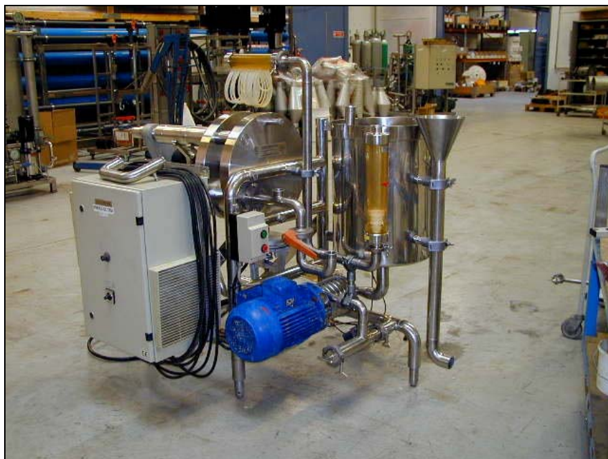
Figur 4.1 Testanlæg anvendt til screening af membraner
