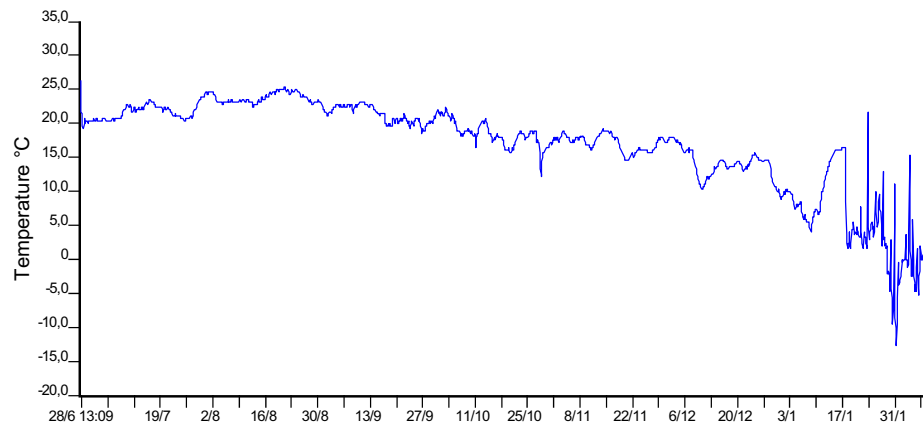
FIG. 6. TEMPERATURFORLØB I 220 L KOMPOSTERINGSBEHOLDER (ANLÆG 1). SAMME BEHOLDER SOM I FIG. 5 OVENFOR, MEN TEMPERATUREN MÅLTES NÆR SIDE AF BEHOLDEREN CA. 30 CM OVER BUND. 19/1 2003 PLACEREDES BEHOLDEREN UDENDØRS.
