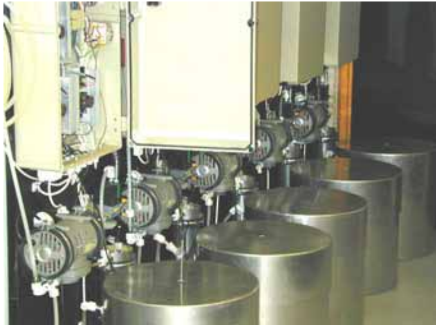
FIG. 6.2. KOMPOSTREAKTORSYSTEMET. REAKTORER MED TILHØRENDE STYRINGSENHEDER.
