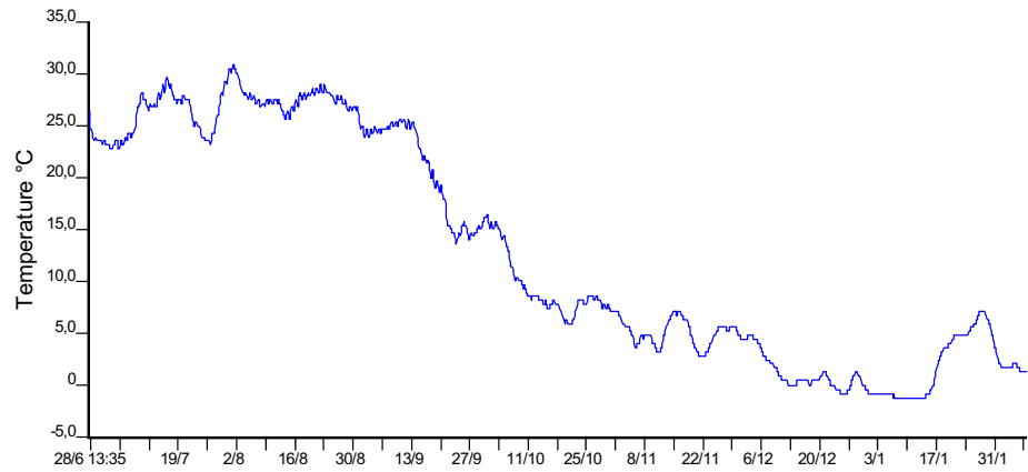
FIG. 11. TEMPERATURFORLØB I FÆLLESKOMPOSTBEHOLDER (ANLÆG 14). SAMME BEHOLDER SOM I FIG. 3.11 I KAPITEL 3, MEN TEMPERATUREN MÅLTES NÆR HJØRNE AF BEHOLDER CA. 30 CM UNDER MATERIALETS OVERFLADE.
