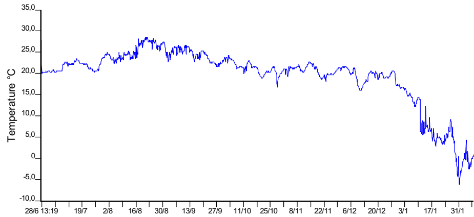
FIG. 7. TEMPERATURFORLØB I 220 L KOMPOSTERINGSBEHOLDER (ANLÆG 2). TEMPERATUREN MÅLTES CENTRALT I BEHOLDEREN CA. 30 CM OVER BUND. 11/1 2003 PLACEREDES BEHOLDEREN UDENDØRS.
