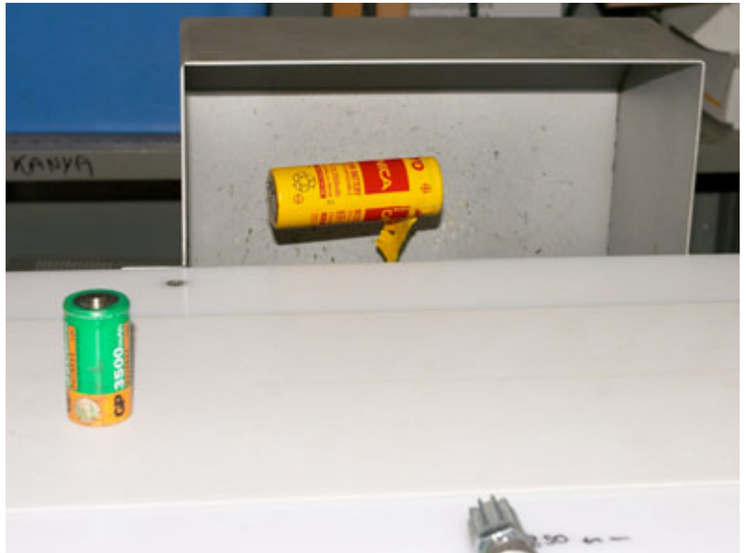
Figur 17. Udkaster; et batteri kastes netop ud
