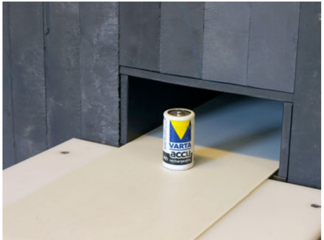
Figur 12. Indgangshullet til målekanalen; transportbåndet igennem denne.
