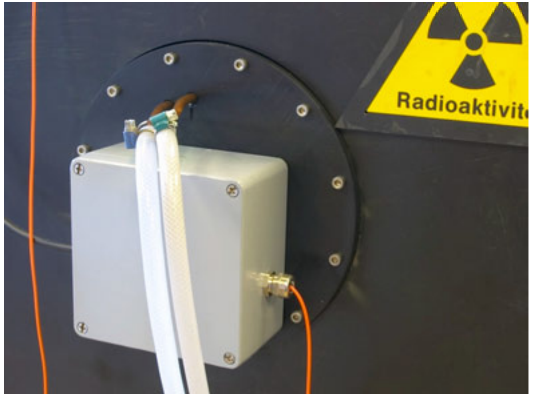
Figur 14. Den ene detektor; slanger til køling kan ses.
