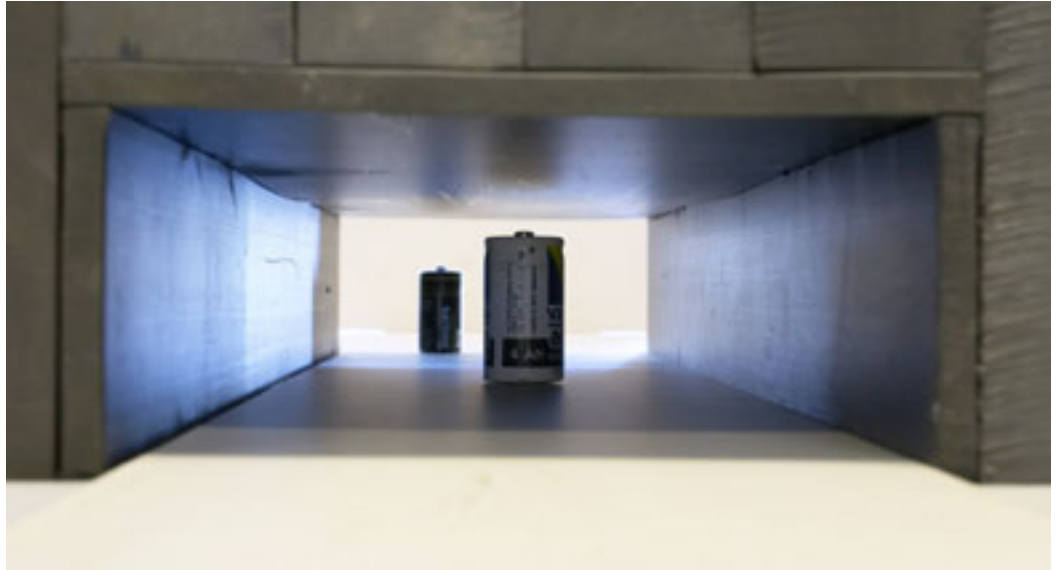
Figur 1. Sensorens målekanal. Det forreste batteri er i centrum af målevoluminet.
