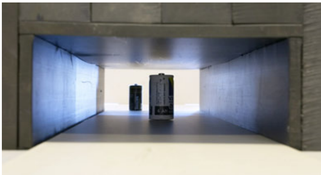
Figur 13. Målekanalen; det forreste batteri er i centrum af målevoluminet.
