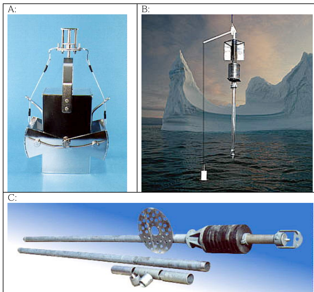
Figur 2.4. Forskellige kerne prøvetagere: A Box-corer; B: Stempel-corer; C: Gravity corer. Alle billeder fra www.kc-denmark.dk .
