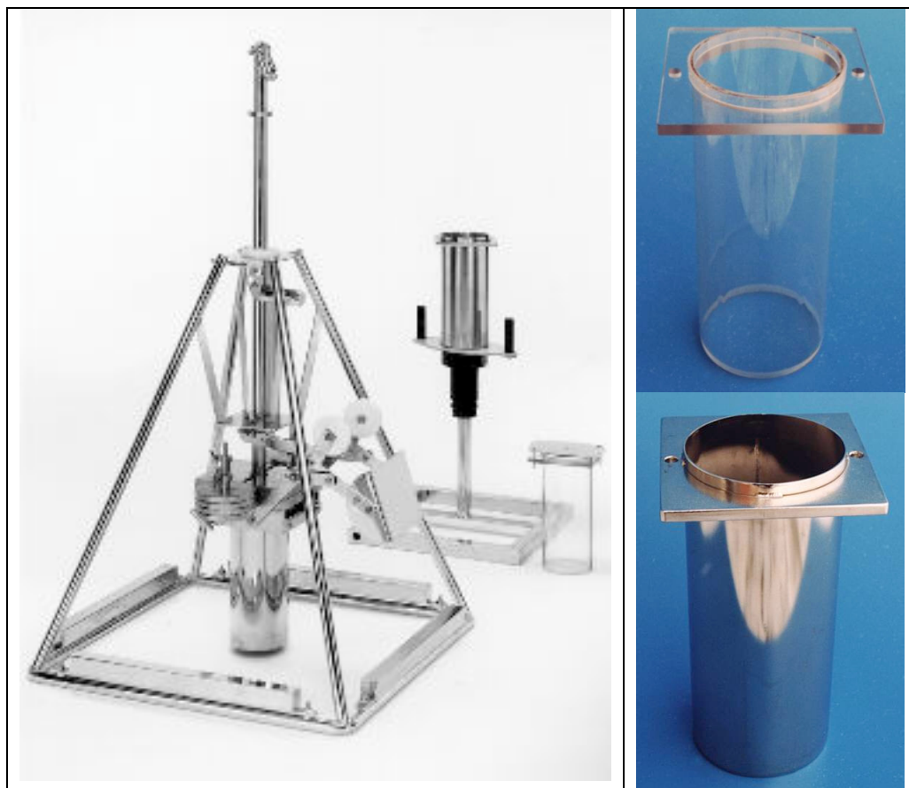
Figur 2.2 En HAPS prøvetager, med selve prøvetagningsrørene i plexiglas (øverst) og rustfrit stål (nederst) afbildet i detalje til højre. Billeder fra www.kc-denmark.dk .
