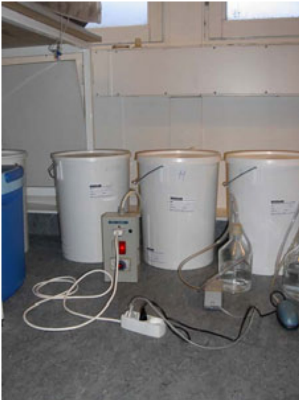
Billede 3 Forsøgsopstilling med timerstyring af lufttilførslen.
