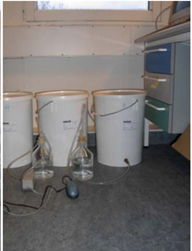
Billede 4 Forsøgsopstilling med befugtning af den tilførte luftstrøm
