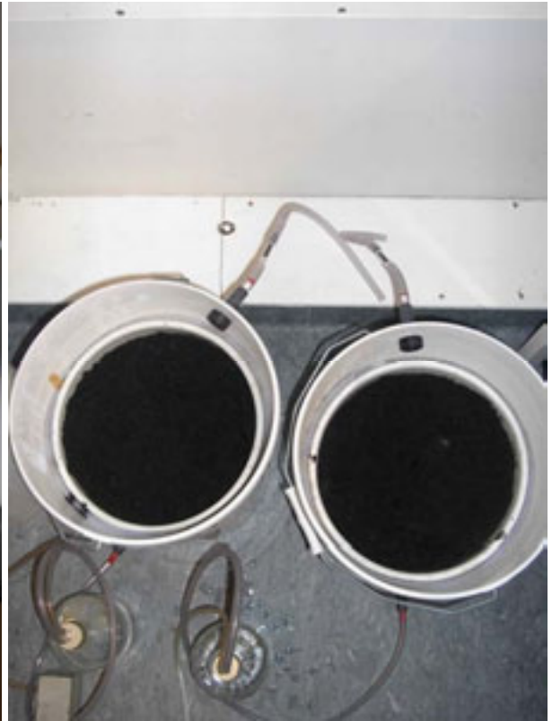
Billede 6 Forsøgsopstilling uden låg. På afgangsstykkerne ses tilkoblede kulrør og aldehydrør
