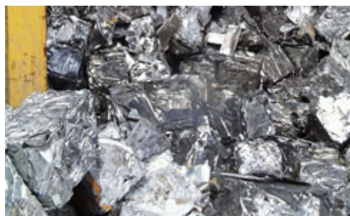
Figur 18. Sammenpresset ulegeret aluminium, klar til omsmel tning. Foto: Karin Strömberg.
