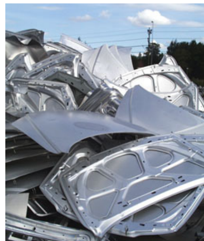
Figur 19: Kølerhjelme af ubehandlet aluminium, klar til omsmelting. Kilde: Strömberg, 2000
