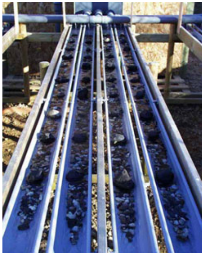
Figur 2.4. Foto af de 3 meter lange substrat-strækninger bestående af grus, sten og elleblade.
