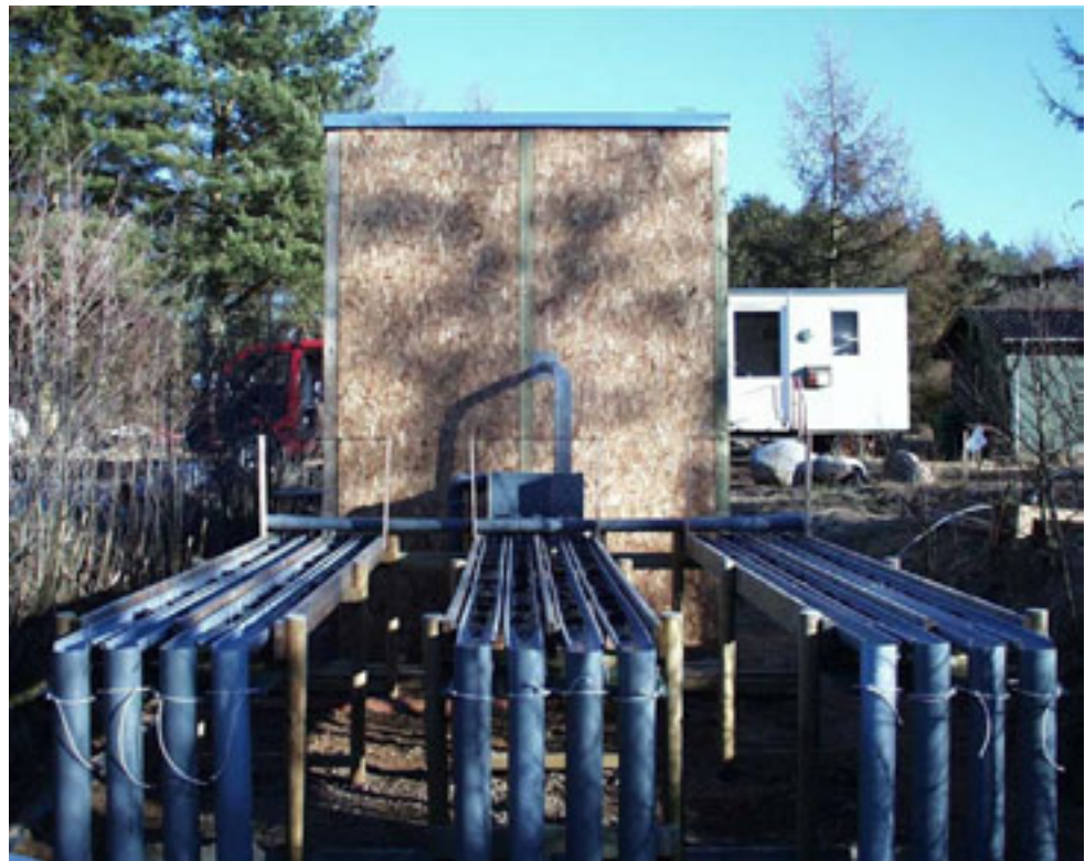
Figur 2.3. Foto af forsøgsopstillingen med de 12 vandløbsrender. Driftnettene er placeret i de lodrette nedløbsrør forrest i billedet.
