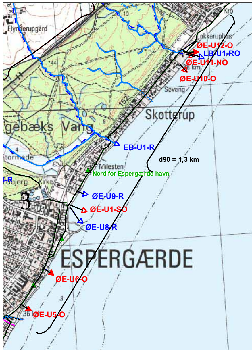
FIGUR 10-6. OPGØRELSE AF PUNKTKILDER I NÆRHEDEN AF BADESTRANDEN "NORD FOR ESPERGÆRDE HAVN". UANSET OM STRØMMEN ER SYD- ELLER NORDGÅENDE ER DER VÆSENTLIGE PUNKTKILDER INDENFOR RELATIVT KORT AFSTAND AF BADESTRANDENE. PUNKTKILDERNE ER SEPARATE REGNUDLEDNINGER (ØE-U8-R, ØE-U9-R, EB-U1-R) OG UDLEDNINGER AF OPSPÆDET ELLER RENSET SPILDEVAND (ØE-U5-O, ØE-U6-O, ØE-U1-SO).
