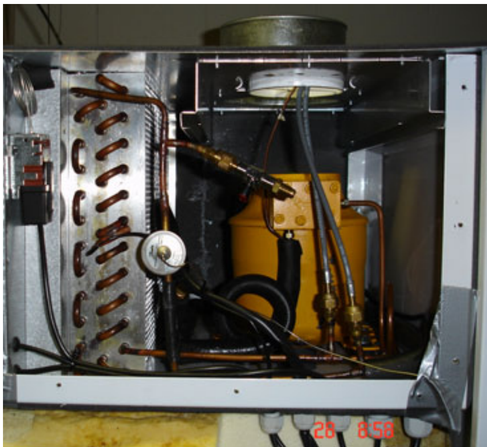
Figur 11: Kølesystem, med fordamper, kompressor og ventil
