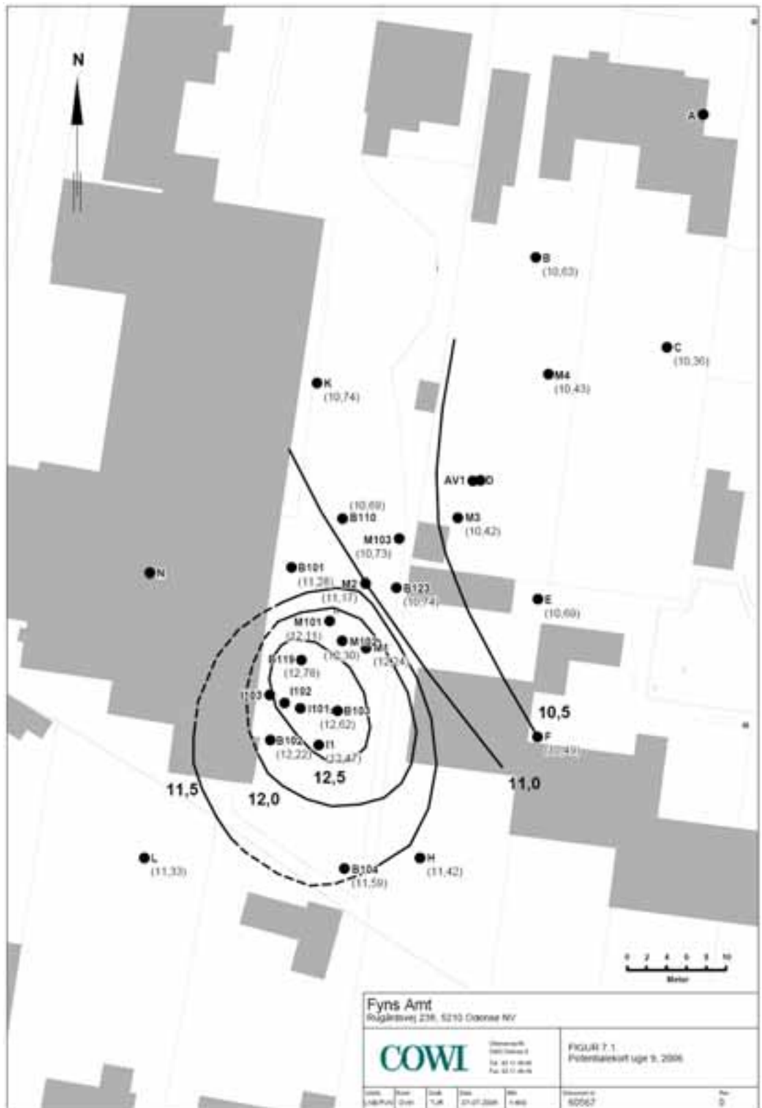
FIGUR 7.2 POTENTIALEKORT FOR MELLEMLSTE SEKUNDÆRE MAGASIN, UGE 9, 2006.
