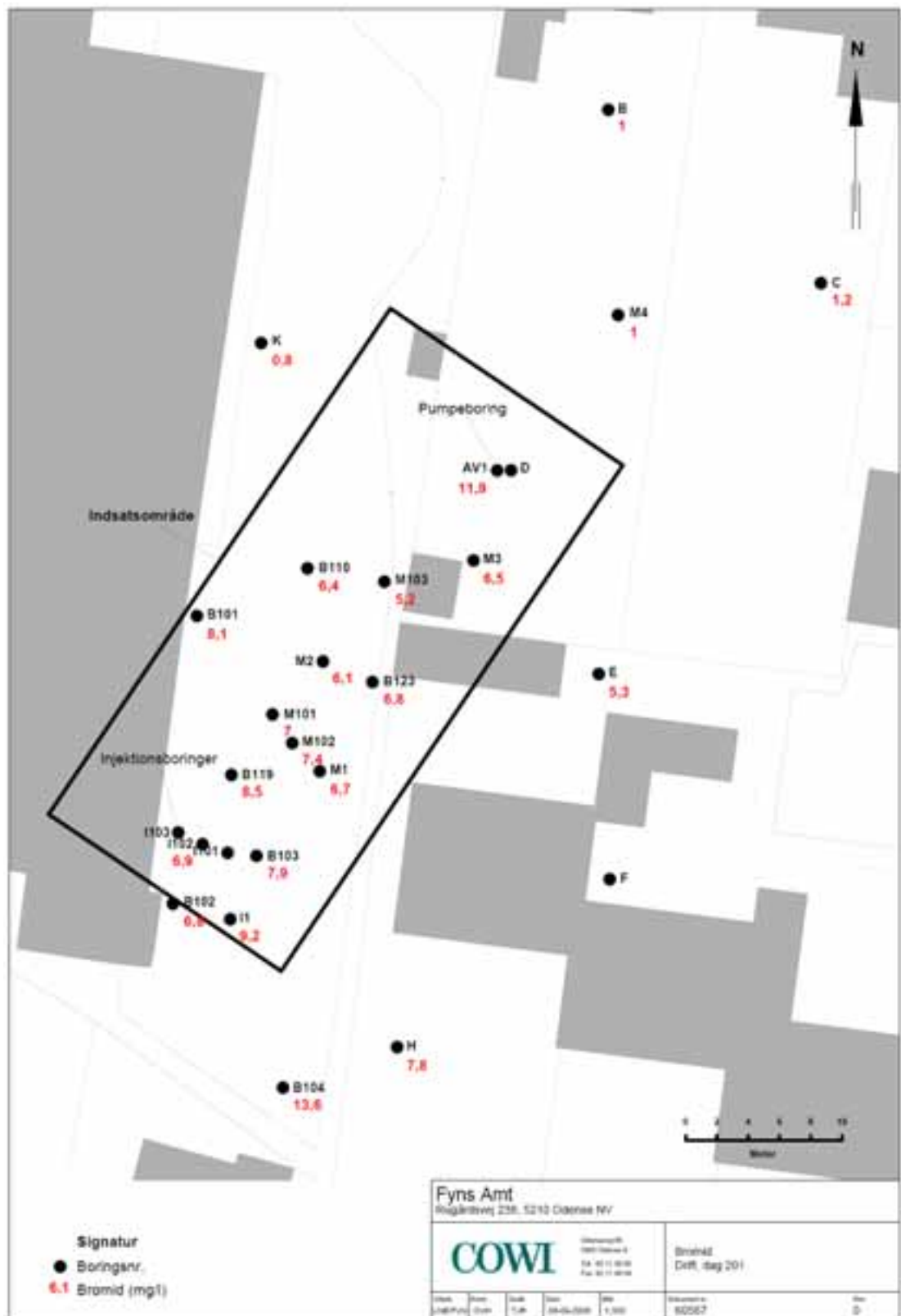
Figur 7.5. Observeret spredning af bromid i pilotforsøget dag 201.
