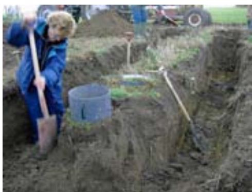
Figur 1.1. Udtagningen af intaktkolonnerne blev forberedt og lettet vha. en rende-graver. Der blev gravet på tværs af agerretningen.
