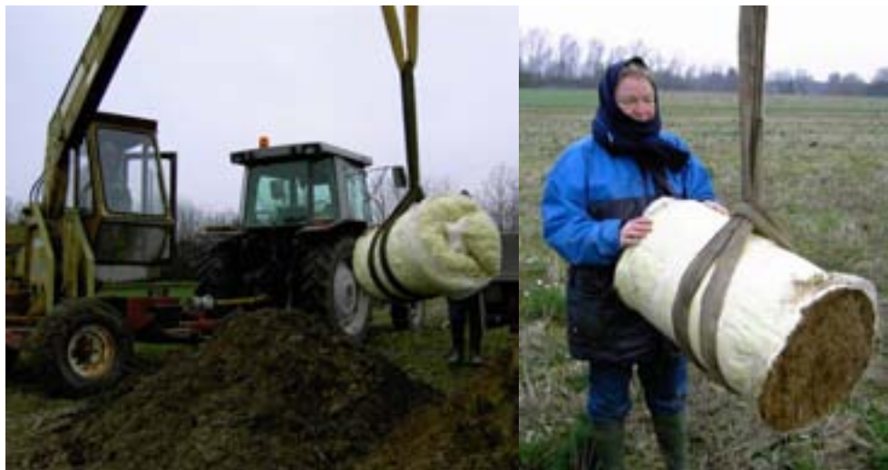
Figur 1.4. Hjemtagning af kolonne fra marken. Figure 1.4. Collection of the soil column from the field.
