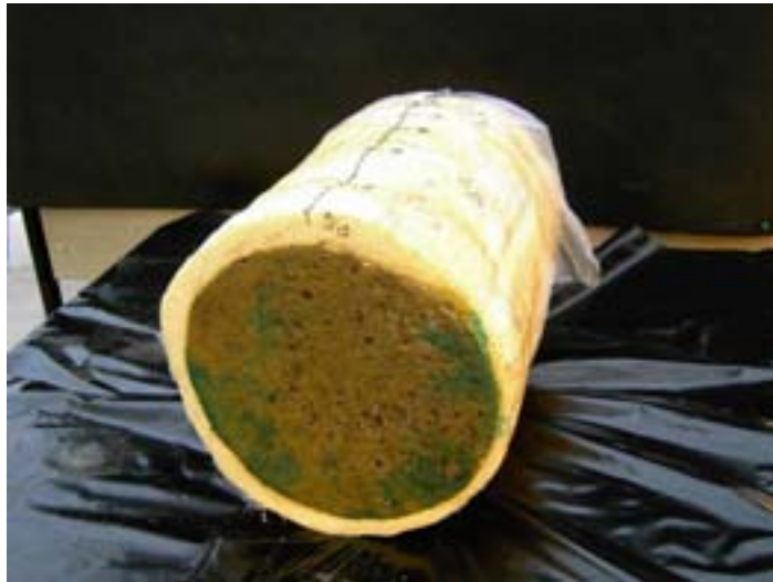
Figur 3.5 Markering af sektionerne på kolonnen (kolonne 2, pløjet mark) startende ved bunden i 50 cm dybde (kolonnediameter = 30 cm). Metoden sikrer bl.a., at billeder af snitfladerne efter opskæringen kan positioneres præcist i forhold hinanden.
