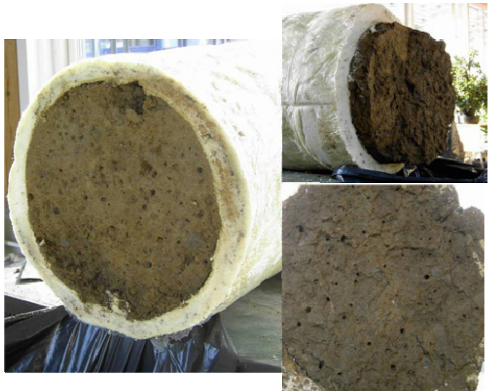
Figur 3.2. Trimning af bunden på kolonnerne (kolonnediameter = 30 cm). Bemærk de mange åbne bioporer (regnormegange) og den tætsluttende celleplast ved kanterne.
