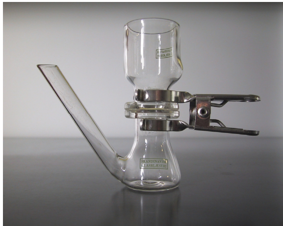
Figur 2. Diffusionscelle af glas til penetrationsforsøg.
