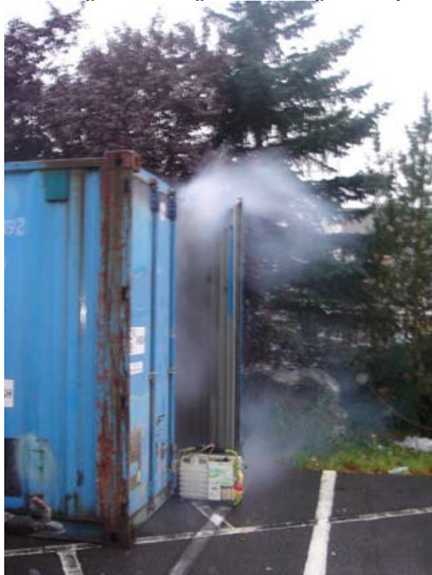
Foto 8: Røglugtsanering af inventar i container. Bemærk den kraftige røgdvikling fra foggeren.
